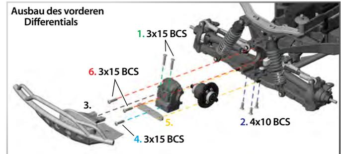
4. Entfernen Sie die 3 x 15 mm Rundkopfschraube von der Differentialbefestigung.
