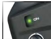
Wenn die Status-LED rot blinkt, sind eventuell die Batterien des Senders schwach, entladen oder nicht richtig installiert. Ersetzen Sie sie mit neuen oder frisch geladenen Batterien. Die Anzeigelampe zeigt nicht den Ladezustand der im Modell installierten Batterie an. Mehr Informationen über Sender, Statusanzeige und LED-Signale finden Sie auf Seite 31 im Abschnitt Fehlerbehebung.
