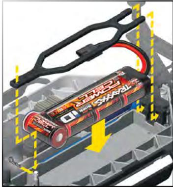
Setzen Sie die Batterie mit den Kabeln zur Rückseite des Modells ein. Setzen Sie die Laschen des Batterie-Niederhalters in die Schlitz auf der Rückseite der Halterung und setzen Sie anschließend den Batterie-Niederhalter über der Abtrennung ein. Sichern Sie den Batterie-Niederhalter mit einem Karosserie-Clip im Loch der Abtrennung. Schließen Sie den Batterie-Pack noch nicht an.
