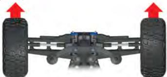
7. Bedienen Sie den Gashebel vorsichtig, um sicherzustellen, dass Ihr Modell vorwärts und rückwärts fährt und dass der Motor stoppt, wenn der Gashebel in der Nullposition steht. **WARNUNG: Geben Sie kein Vollgas, weder vorwärts noch rückwärts, solange sich das Modell nicht auf dem Boden befindet.**
