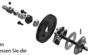
• **Antriebsstrang:** Untersuchen Sie den Antriebsstrang auf Anzeichen von Verschleiß wie abgenutzte Antriebsbügel, schmutzige Achs-Halbwellen und andere ungewöhnliche Störungen oder Blockierungen. Wenn ein U-Gelenk auseinander springt, ist es an der Zeit, das Teil zu ersetzen. Entfernen Sie die Getriebeabdeckung. Untersuchen Sie die Zahnräder auf Abnutzung und überprüfen Sie, dass alle Schrauben fest angezogen sind. Die einzelnen Komponenten wie erforderlich festziehen, reinigen oder ersetzen.
