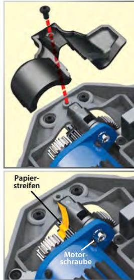
Zur Einstellung des Zahneingriffs lösen Sie die Motorschraube. Schneiden Sie einen dünnen Streifen Papier ab und legen Sie es zwischen die Zahnräder. Schieben Sie den Motor nach vorne, damit das Ritzel in das Zahnrad eingreift. Ziehen Sie die Schrauben des Motors fest und entfernen Sie den Streifen Papier. Der Papierstreifen sollte durch die Zahnräder bewegt werden können, ohne dass er klemmt.
